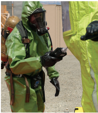
Werkers kunnen VOC's eenvoudig meten en metingen draadloos verzenden tot een afstand van 3 km.
